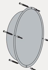
> Befestigung an der Wand durch mitgelieferte Dübel und Schrauben
